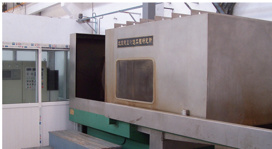
图2 北京航空制造工程研究所研制的航空发动机机匣电解加工设备
